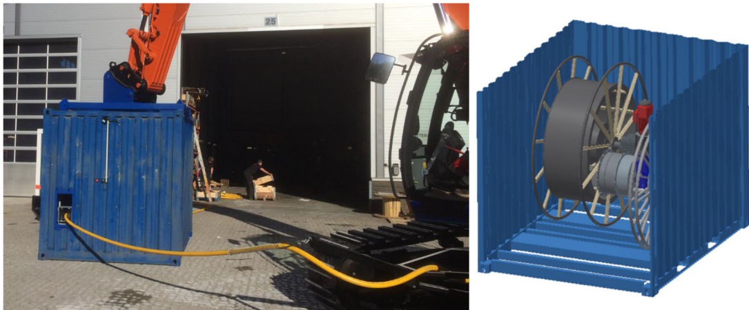
Figur 8. Diagram og bilde av motoriserte og fjernstyrte kabeltromler. Kilde: NASTA.
