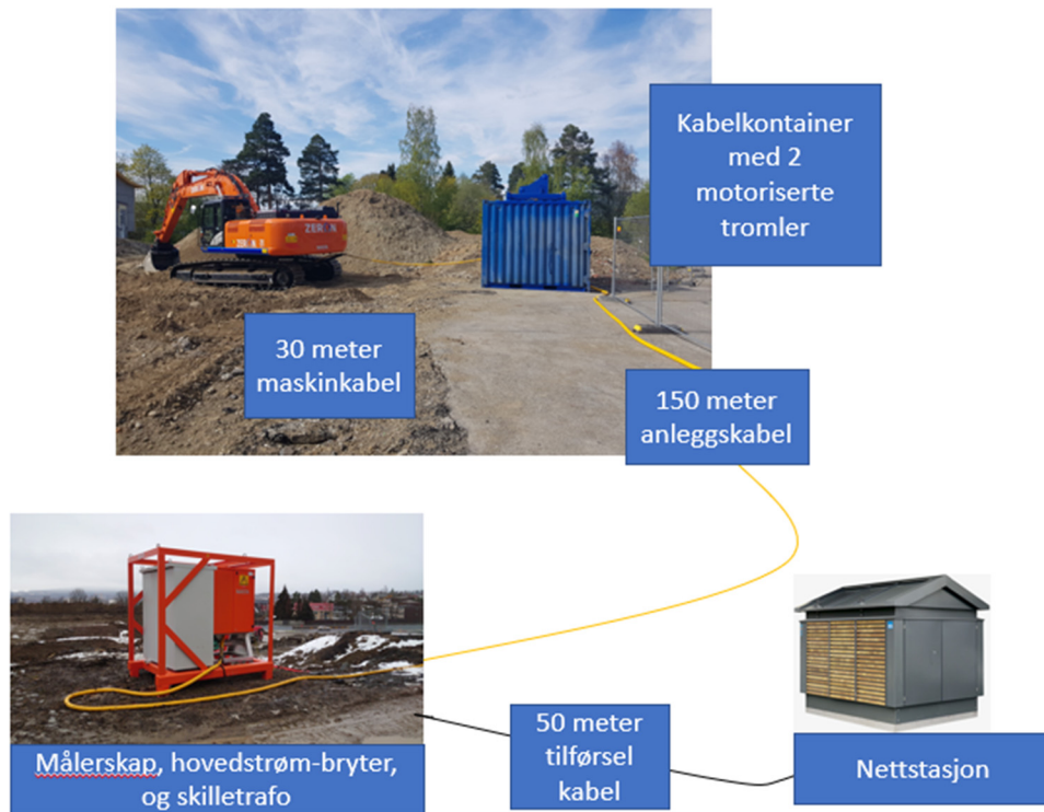
Figur 9. Diagram av kabelløsning med motoriserte, fjernstyrte kabeltromler. Kilde: NASTA.
