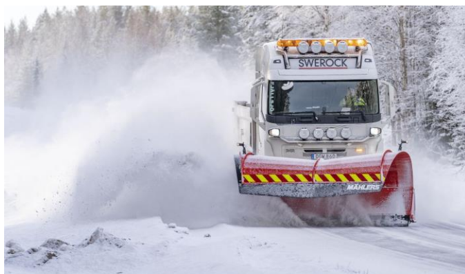
3PM fås i tre bredder: 3700, 4000 og 4300 mm. (Foto: Sten Strömgren/Mählers)
