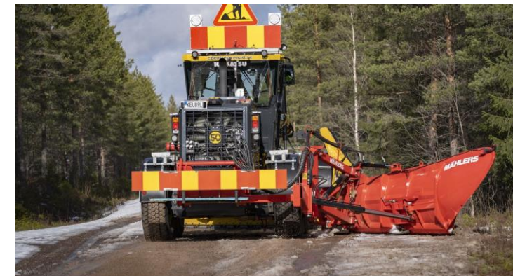
Den nye veihevelen er utstyrt med unike og spesiallagde fester for sideplog, snestopper og grusstrengspreder. (Foto: Sten Strömgren)
